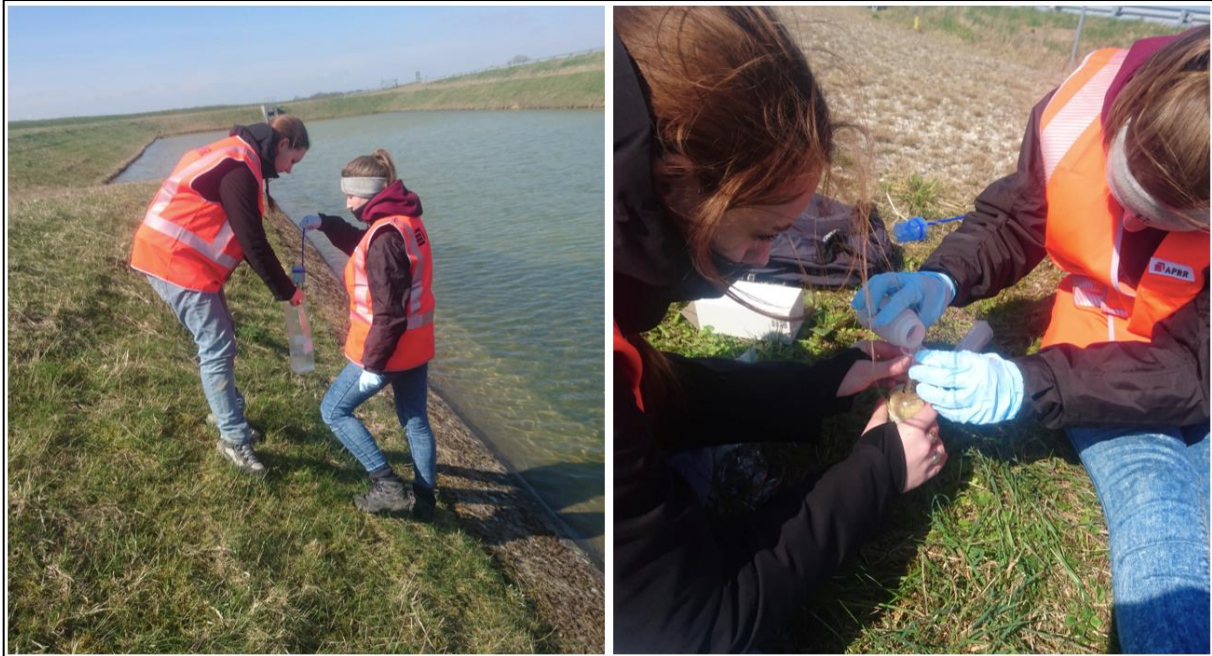
FIGURE 4 : REALISATION DES PRELEVEMENTS D'EAU SUR UN BASSIN DE L'A77 EN MARS 2018
